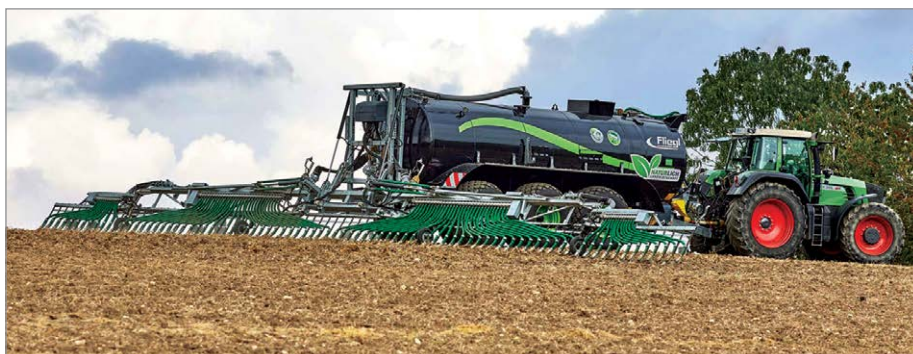
Стремясь сократить потери азота с аммиаком и сдержать распространение неприятных запахов, передовые хозяйства заделывают органику в почву сразу при внесении.
