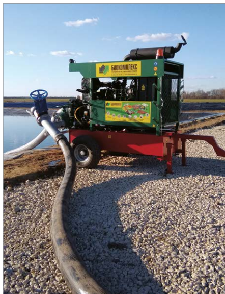
Альтернативой транспортировке и внесению навозной жижи на поля цистернами стали шланговые системы. Предлагаемые рынком технические решения позволяли организовать перекачку жидкого удобрения даже на те поля, что находились от животноводческих комплексов на существенном удалении.
