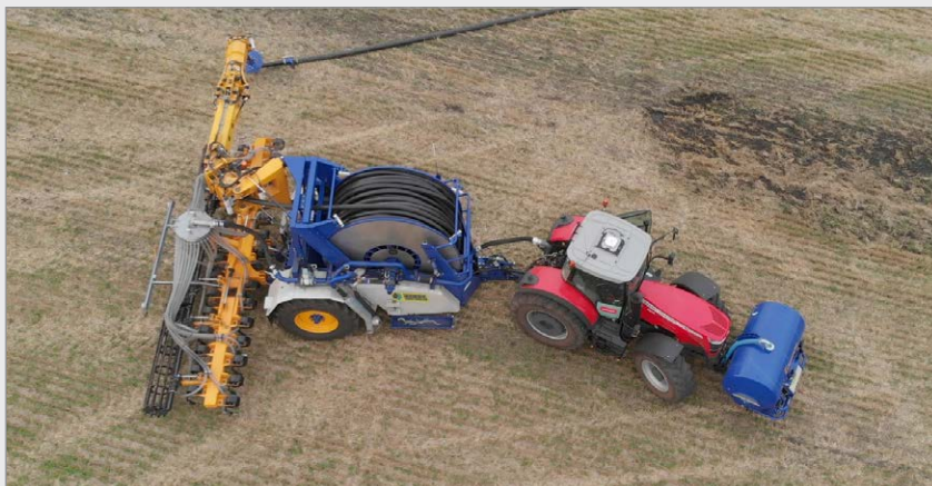
Шланговая система датского производства Agrometer SDS-1200 уже второй год работает на полях одного из хозяйств Белгородской области.
