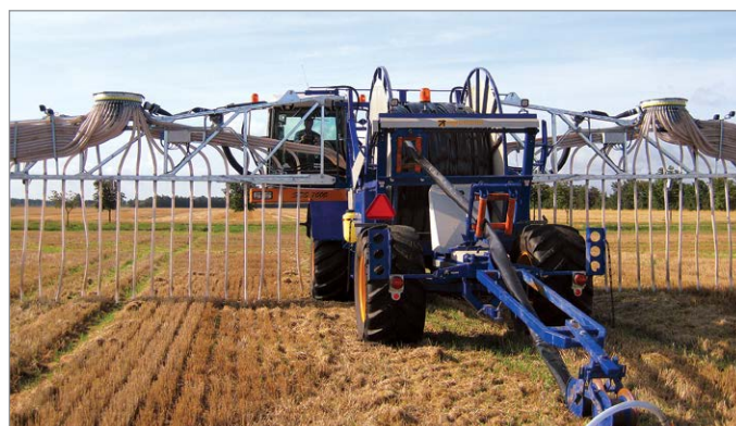
У самоходных систем кабина сдвигается в сторону, что существенно упрощает управление машиной при движении «обратно».
