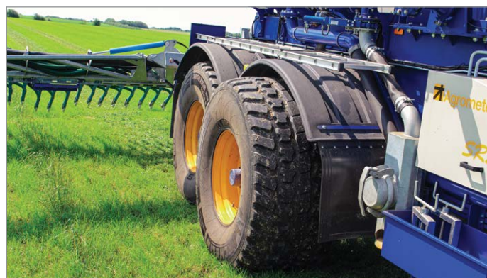
Прицепные системы Agrometer отличаются телескопической задней осью: пары колес двигаются по разным колеям.
