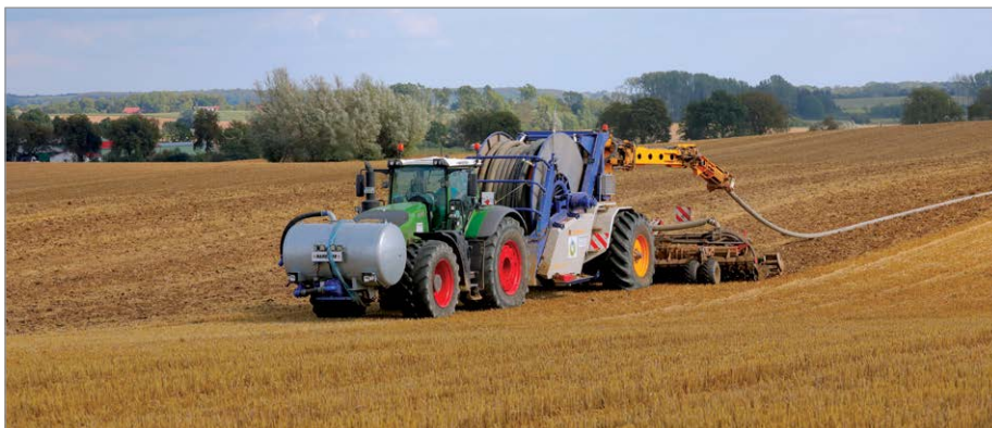
При использовании шланговых систем для внесения жидкого навоза для его заделки можно задействовать дисковую борону, а также культиватор для полосовой технологии или же щелеватель. Этим активно пользуется Бьёрн Зальцведель, организующий работу филиала машинно-тракторной станции.
