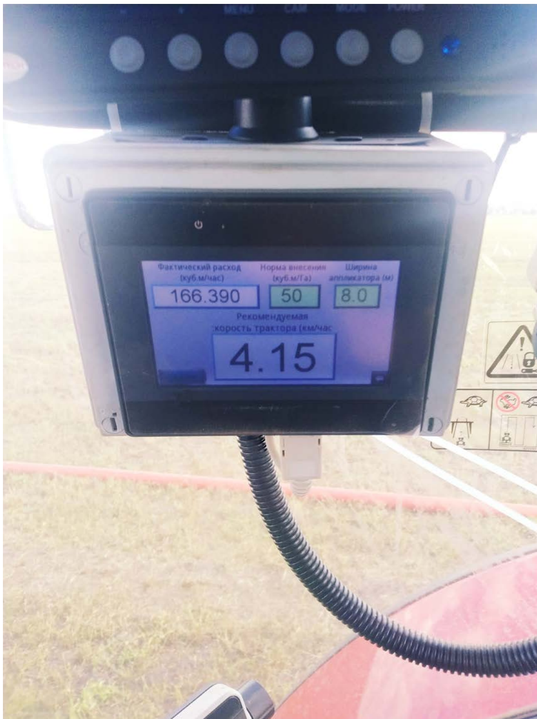
Рис.5. Система расчета скорости движения трактора в работе
