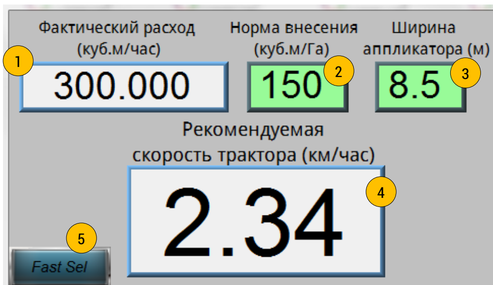
Рис.4. Главное меню системы (1 – окно, отображающее «Фактический расход вносимого продукта»; 2 – окно, предназначенное для ввода значения «Требуемой нормы внесения продукта»; 3 - окно, предназначенное для ввода значения «ширины рабочего органа внесения»; 4 - расчетная величина рекомендуемой скорости трактора для выполнения условий по «Требуемой нормы внесения продукта»; 5 – кнопка выбора окна - главного или установки).
